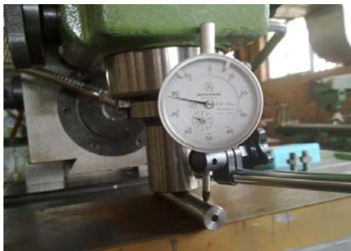
شکل (۱۰): نمایش وضعیت قرار گرفتن ساعت اندیکاتور برای تعیین مقدار واقعی عمق نفوذ.
