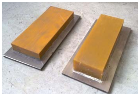
شکل (۶): بستر لاستیکی با ضخامت ۵۰ میلی متر (سمت راست) و با ضخامت ۳۵ میلی متر (سمت چپ).
