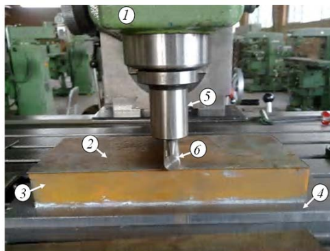
شکل (۹): تجهیزات آزمایش خمش ورق.
